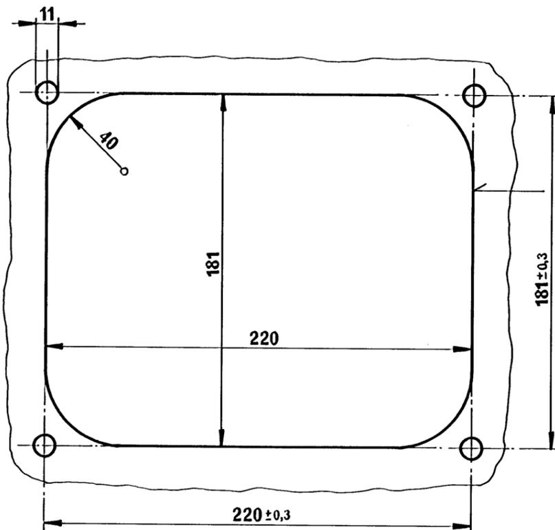
Erforderlicher Ausschnitt zum Einbau der Anzeigevorrichtung
